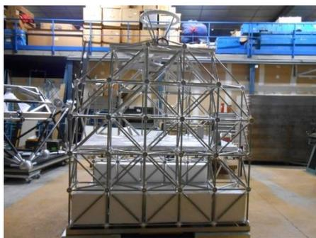
*Photographies de la nacelle d'emport CARMEN. Le dispositif de création sera positionné sur l'un des alvéoles qui se situe sur le côté de la nacelle (les murs)*
